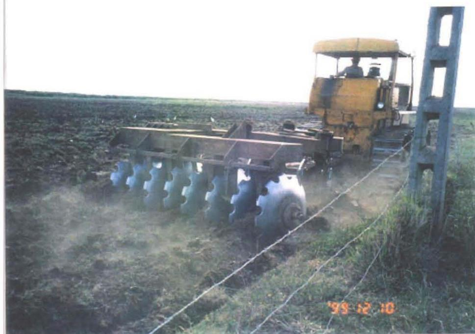
大型トラクターで牽引されるディスクハロー
