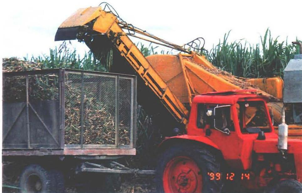
収穫機の積み込み機構部分
