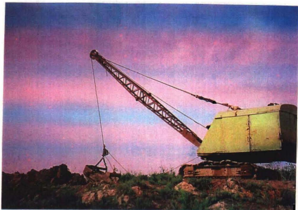
ドラグラインによる灌漑水路 の浚渫作業(Sabirabad I.S.O)
